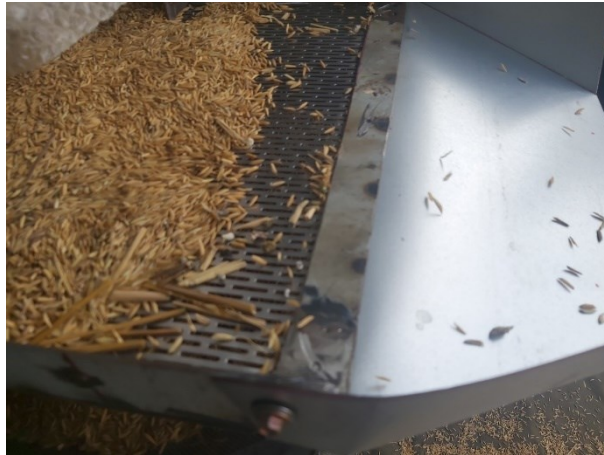
รูปภาพที่ 4.5 ลักษณะข้าวเปลือกที่มากองบริเวณด้านหน้าตะแกรงโยก
