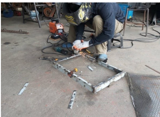
รูปภาพที่ 3.8 แสดงการสร้างประกอบเครื่องทำความสะอาดข้าวเปลือกแบบประยุกต์ต้นแบบ
