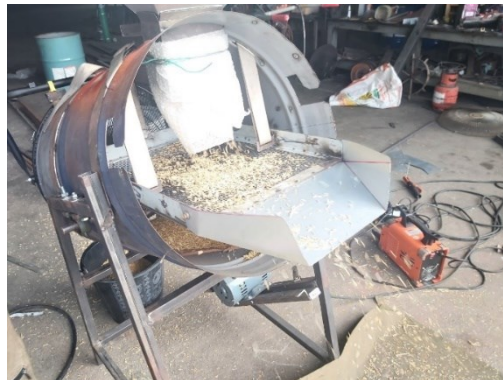
รูปภาพที่ 4.3 การทดสอบหาความเร็วลมที่เหมาะสม ที่มีมลัดเอียงของตะแกรงโยก 10.01 องศา
