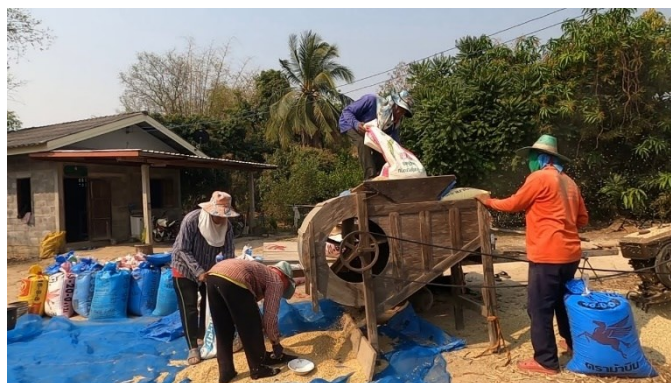
รูปภาพที่ 2.5 การคัดแยกข้าวเปลือกโดยใช้ลม (เครื่องสีฟัดข้าว)
