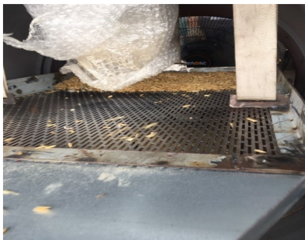
รูปภาพที่ 4.6 ลักษณะข้าวเปลือกที่มากองบริเวณด้านหลังตะแกรงโยก
