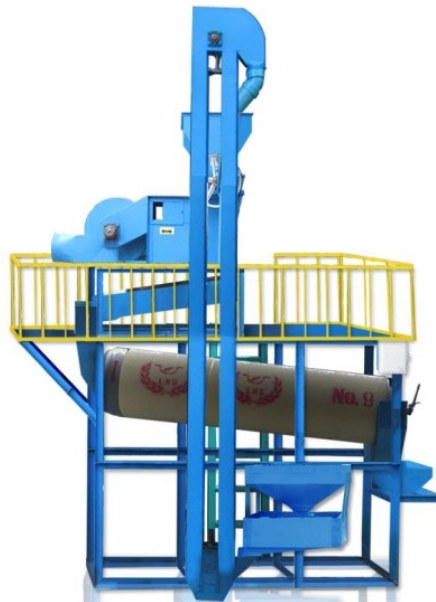
รูปภาพที่ 2.13 เครื่องคัดแยกและทำความสะอาดข้าวเปลือกแบบตะแกรงกลมหมุนและลมเป่า
