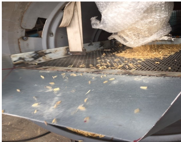
รูปภาพที่ 4.8 ลักษณะการกระจายตัวของข้าวเปลือก ที่มุมเอียงตะแกรงโยก 8.06 องศา
